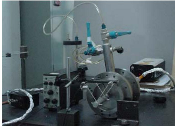
Figura 5.15 Sistema de excitação do protótipo.
