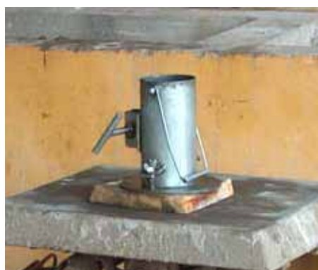
Figura 6.46 – Fôrma metálica dos CPs cilíndricos.
