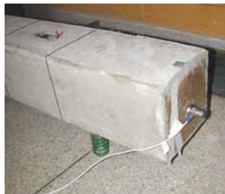
Figura 6.15 – Ensaio dinâmico – frequência longitudinal.
