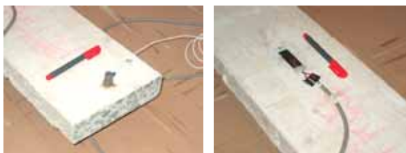
Figura 5.6 – Vigas de concreto armado instrumentadas com extensômetros colados e acelerômetro.
