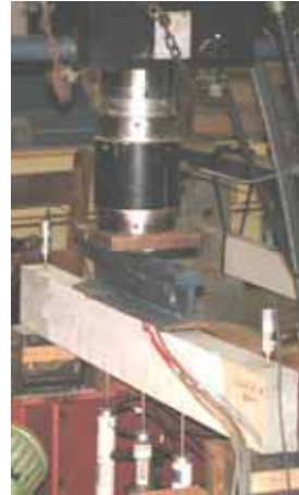
Figura 6.55 – Aplicação do carregamento estático – Atuador servo-hidráulico.
