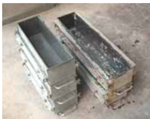
Figura 6.45 – Fôrmas metálicas dos prismas.
