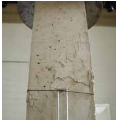
Figura 6.35 – Ruptura por esmagamento do concreto.
