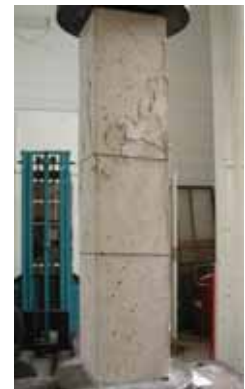
Figura 6.35 – Ruptura por esmagamento do concreto.
