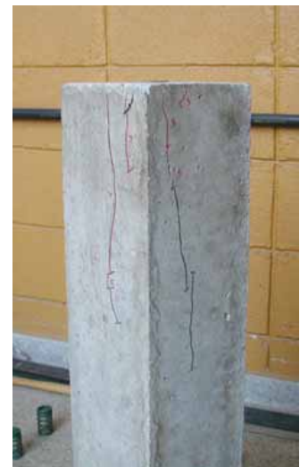
Figura 5.29 – Prisma prB após a ruptura.
