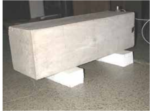
Figura 5.16 – Ensaio com o prisma – frequência transversal – EPS.
