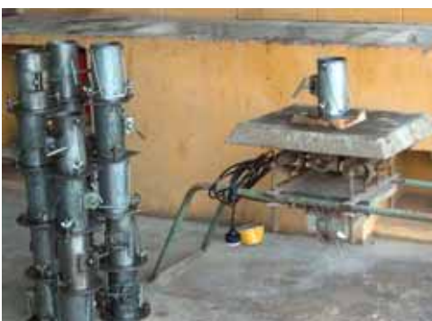
Figura 6.4 – Formas metálicas – CPs cilíndricos. Mesa vibratória.
