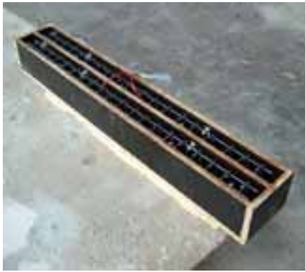
Figura 6.41 – Fôrma de madeira das vigas. Mesa vibratória.
