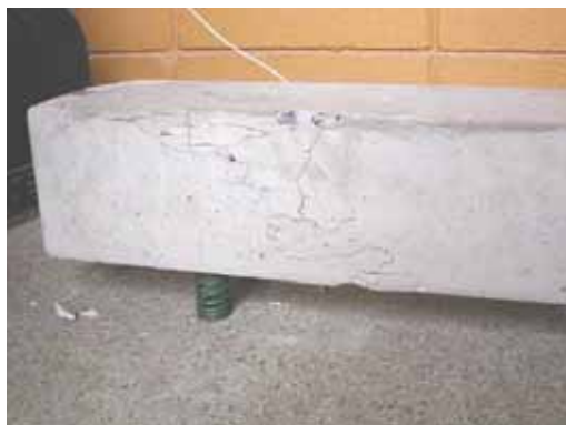
Figura 6.14 – Ensaio dinâmico – após a ruptura do corpo-de-prova.
