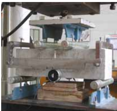
Figura 6.50 – Detalhe do dispositivo de ensaio. Prisma 50 cm.
