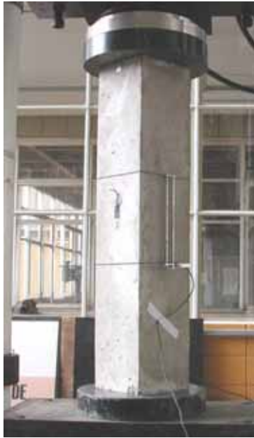
Figura 6.17 – Aplicação do carregamento estático – prisma.
