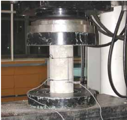
Figura 5.25 – Disposição dos extensômetros removíveis no corpo-de-prova cilíndrico.
