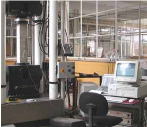
Figura 6.8 – Prisma na máquina de ensaio Instron e sistema de aquisição.
