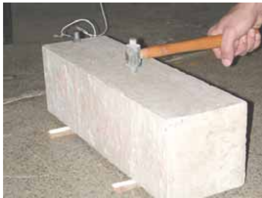
Figura 5.17 – Ensaio com o prisma – frequência transversal – madeira.
