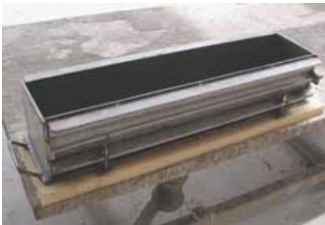
Figura 6.2 – Forma metálica - prisma. Mesa vibratória.
