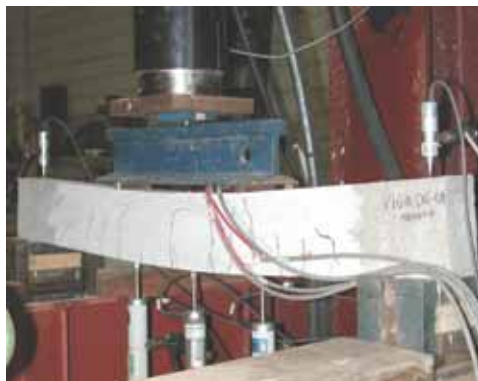
Figura 6.59 – Aplicação do carregamento estático.
