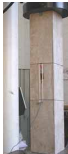
Figura 5.28 – Prisma prB na máquina de ensaio Instron.
