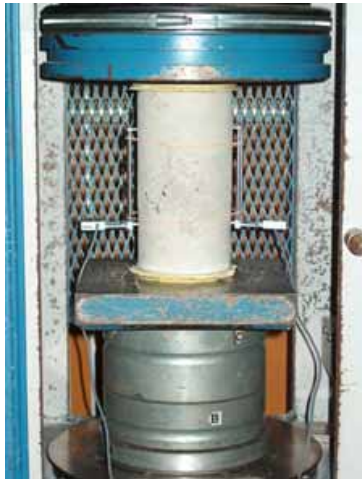
Figura 5.2 – Disposição dos extensômetros removíveis.
