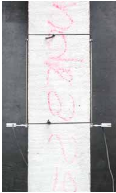
Figura 6.18 – Posicionamento dos extensômetros removíveis.
