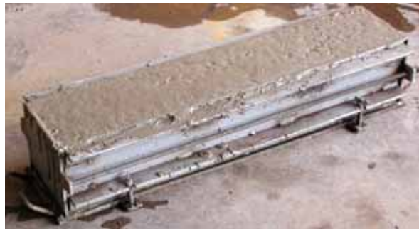
Figura 6.3 – Moldagem do prisma.
