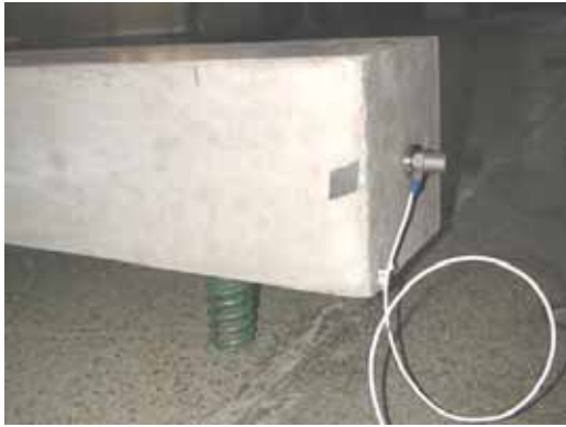
Figura 5.15 – Ensaio com o prisma – frequência longitudinal – molas.
