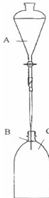
Figura 6: Frasco de microextração utilizado por Zapf, Heyer e Stan (a) Funil de separação com solução saturada de NaCl, (b) camada de solvente tolueno e (c) amostra Fonte: Zapf, Heyer e Stan, 1995
