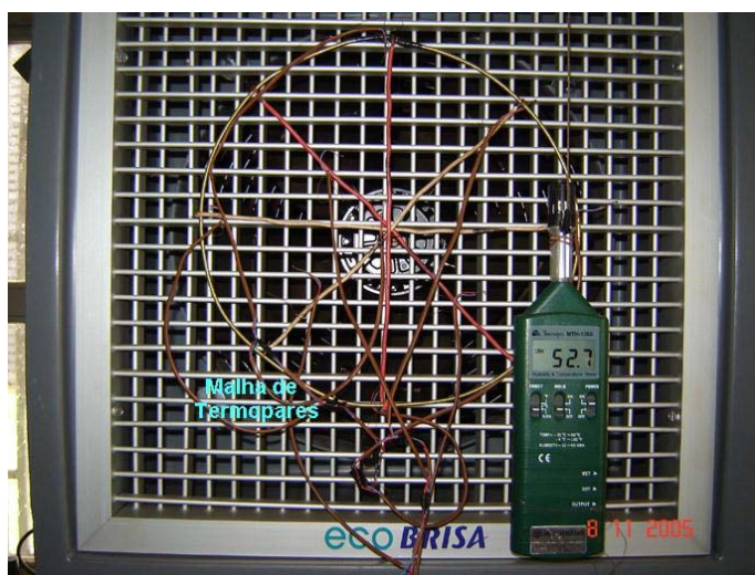
Figura 4.15 – Malha de termopares na saída do ar do resfriador
