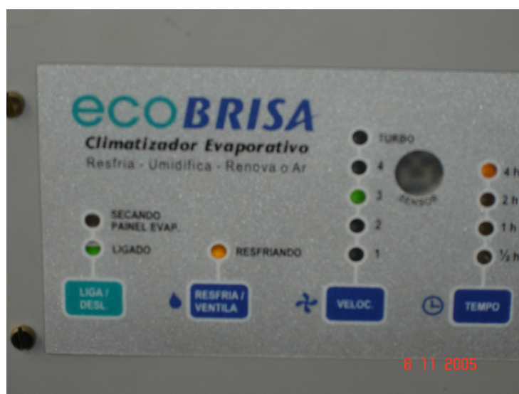
Figura 4.4 – Painel de comando
