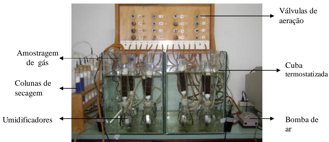
FIGURA 3.5. Dispositivo FES de laboratório com duas cubas termostaticadas que podem reunir 8 colunas de Raimbault.
