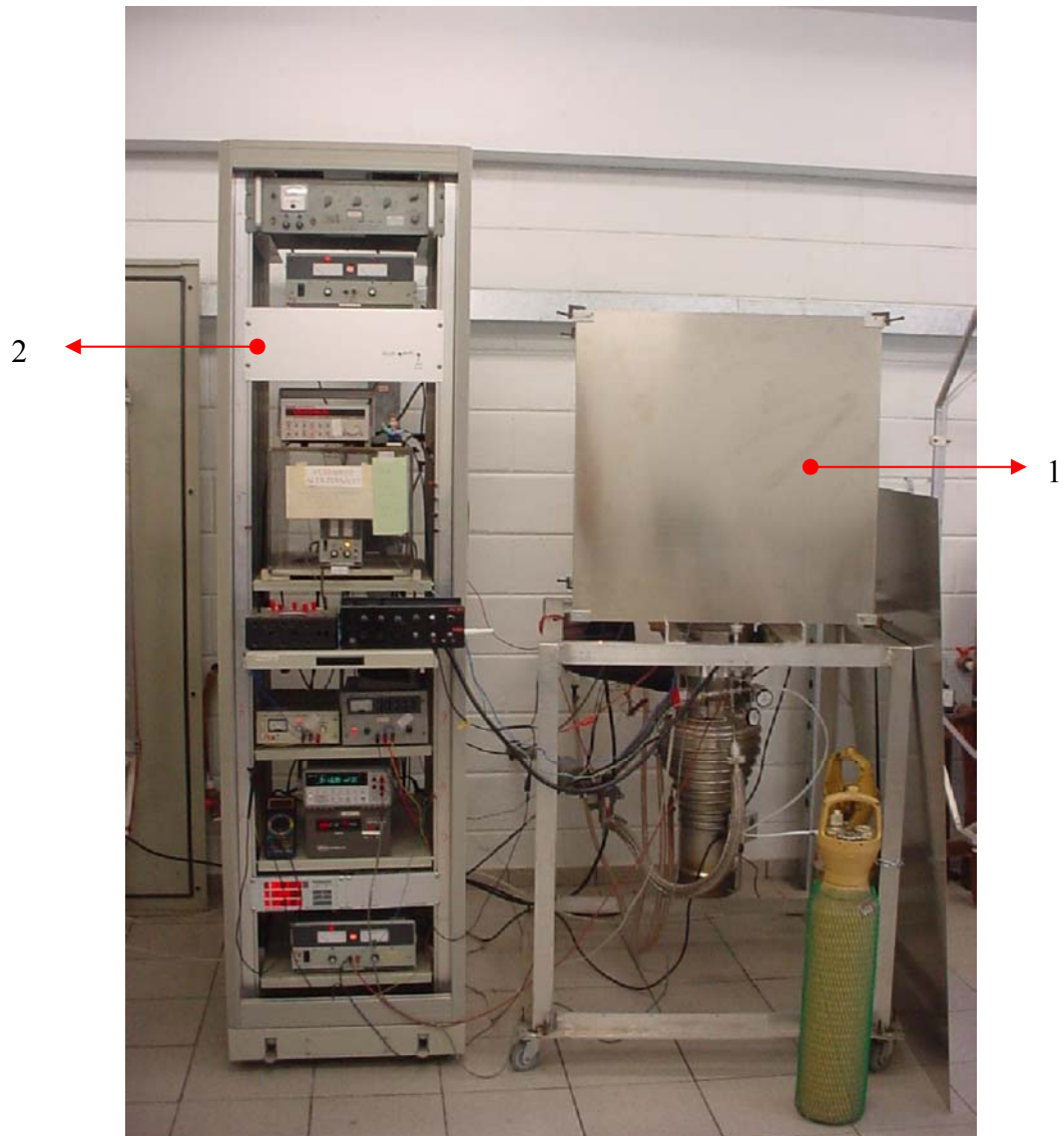
FIGURA 5.4 – (1) caixa de mu-metal, (2) rack com fontes de tensão e corrente.
