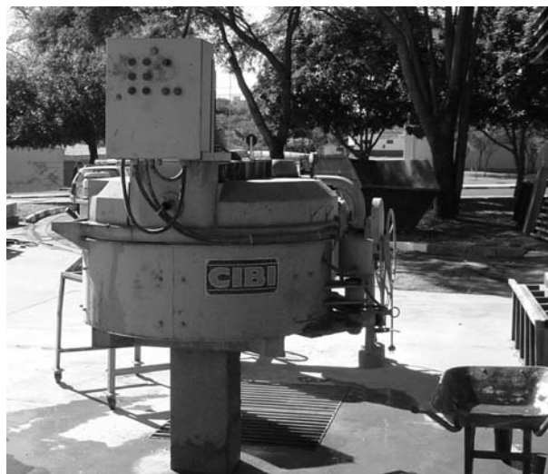
Figura 5.8 – Betoneira de eixo vertical utilizada
