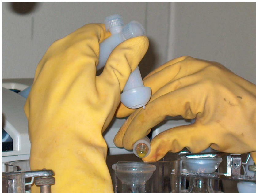
FIGURA 4.7. Introdução da alíquota de óleo encapsulada na parte superior do condensador conectado ao frasco de digestão contendo a mistura ácida aquecida.
