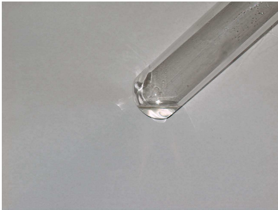
FIGURA 5.13 – Digerido obtido com o procedimento de adição de óleo encapsulado sobre a mistura ácida aquecida no forno de microondas com radiação focalizada.
