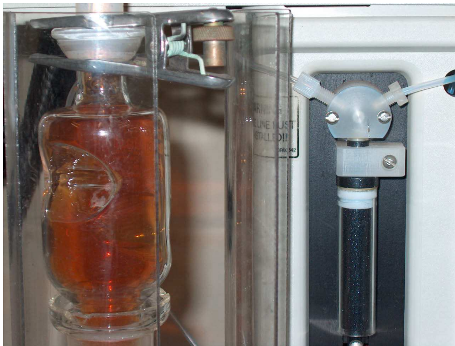
FIGURA 4.4. Seringa do forno de microondas com radiação focalizada responsável pela adição de reagentes e amostras ao longo de programas de aquecimento.
