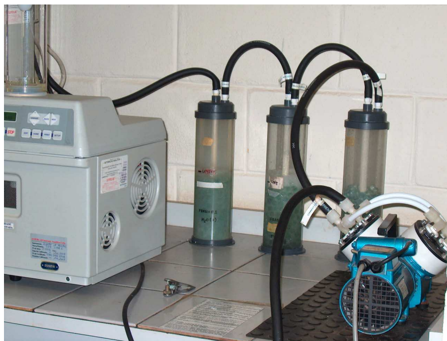
FIGURA 4.5. Frascos lavadores para coleta e neutralização dos vapores ácidos a partir de aspiração efetuada pela bomba de vácuo.
