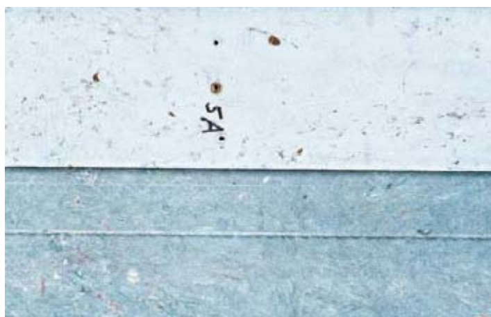
Figura 6.4. Clareamento do PEAD como resultado da radiação UV. Fonte: LYNCH et al., 2001
