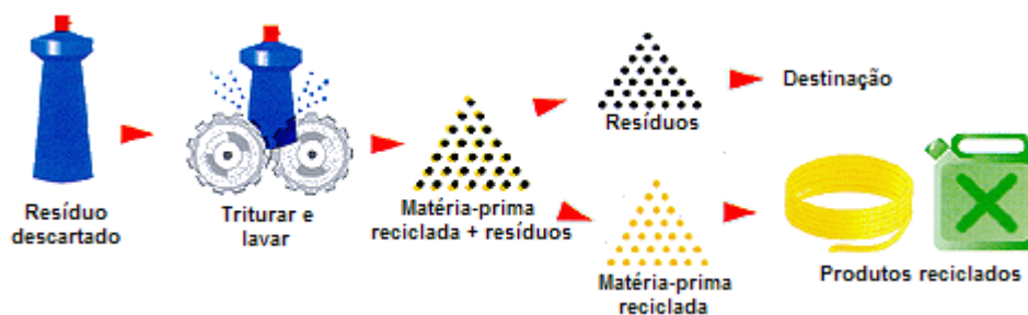
Figura 8.3. As etapas da reciclagem mecânica. Fonte: www.plastvida.org.br
