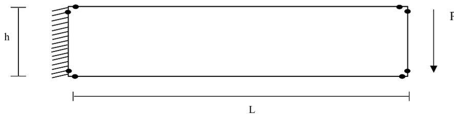
Figura 6.16: Viga em Balanço
