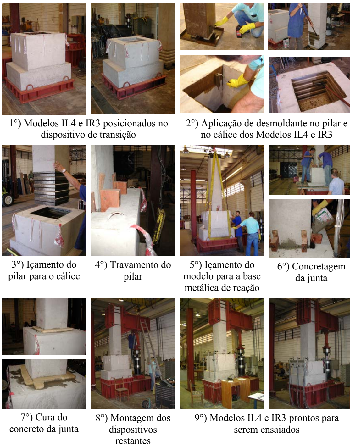
Figura 3.22 – Montagem dos Protótipos IL4 e IR3
