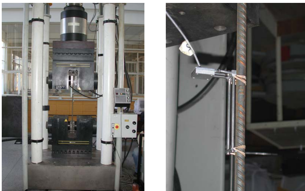
Figura 3.24 – Ensaio a tração da armadura
