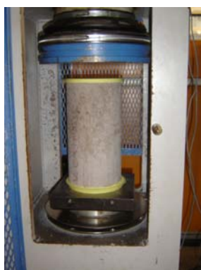
Ensaio a compressão do concreto
