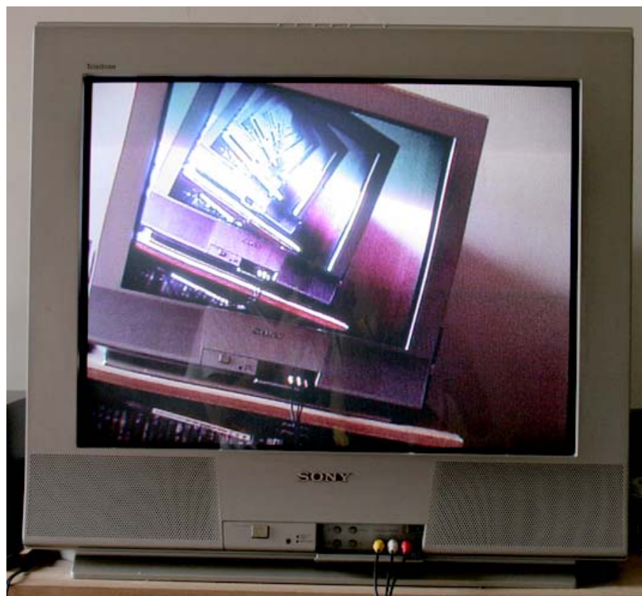
Figura 29: Um caso simples de videofeedback , obtido ao conectar uma câmera de vídeo a uma televisão e apontá-la para o monitor.
