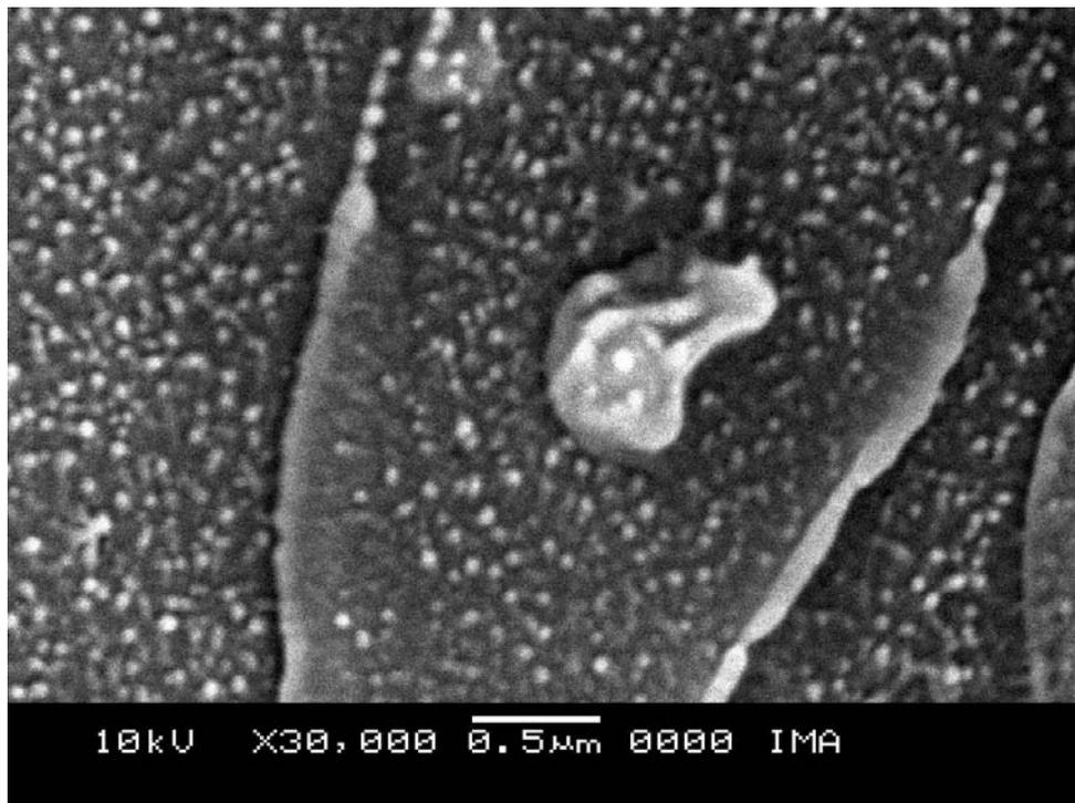
Figura 57. Microscopia do compósito PET + 5% ZrP.H<sub>2</sub>O (30.000X )
