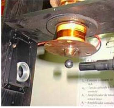
FIG. 3.6: Levitador magnético (Laboratório de Controle, IME)
