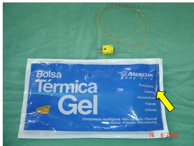
FIGURA 7 - Bolsa térmica utilizada para a promoção do aquecimento articular. Observa-se termopar com a extremidade inserida na bolsa (seta)
