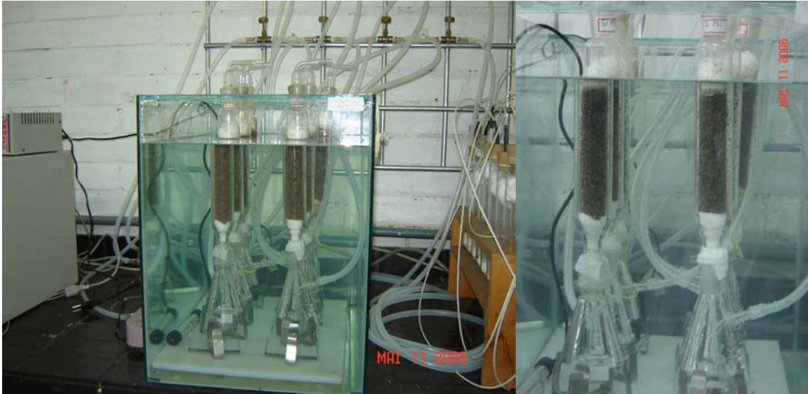
FIGURA 3.1. Fermentações em colunas aeradas.
