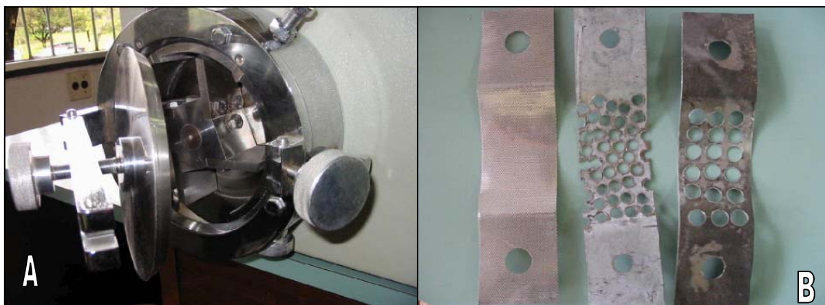
FIGURA 3 – FRAGMENTADOR DO TIPO FACA ROTATIVA USADA PARA TRITURAR O BAGAÇO EM PARTÍCULAS MENORES (A), E AS PENEIRAS DIMENSIONADAS E UTILIZADAS (B).
