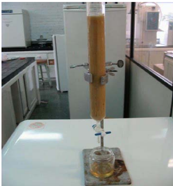
FIGURA 4 – COLUNA MONTADA PARA A EXTRAÇÃO TIPO SÓLIDO-LÍQUIDO COM VÁRIOS TIPOS DE SOLVENTES (MISTURAS)
