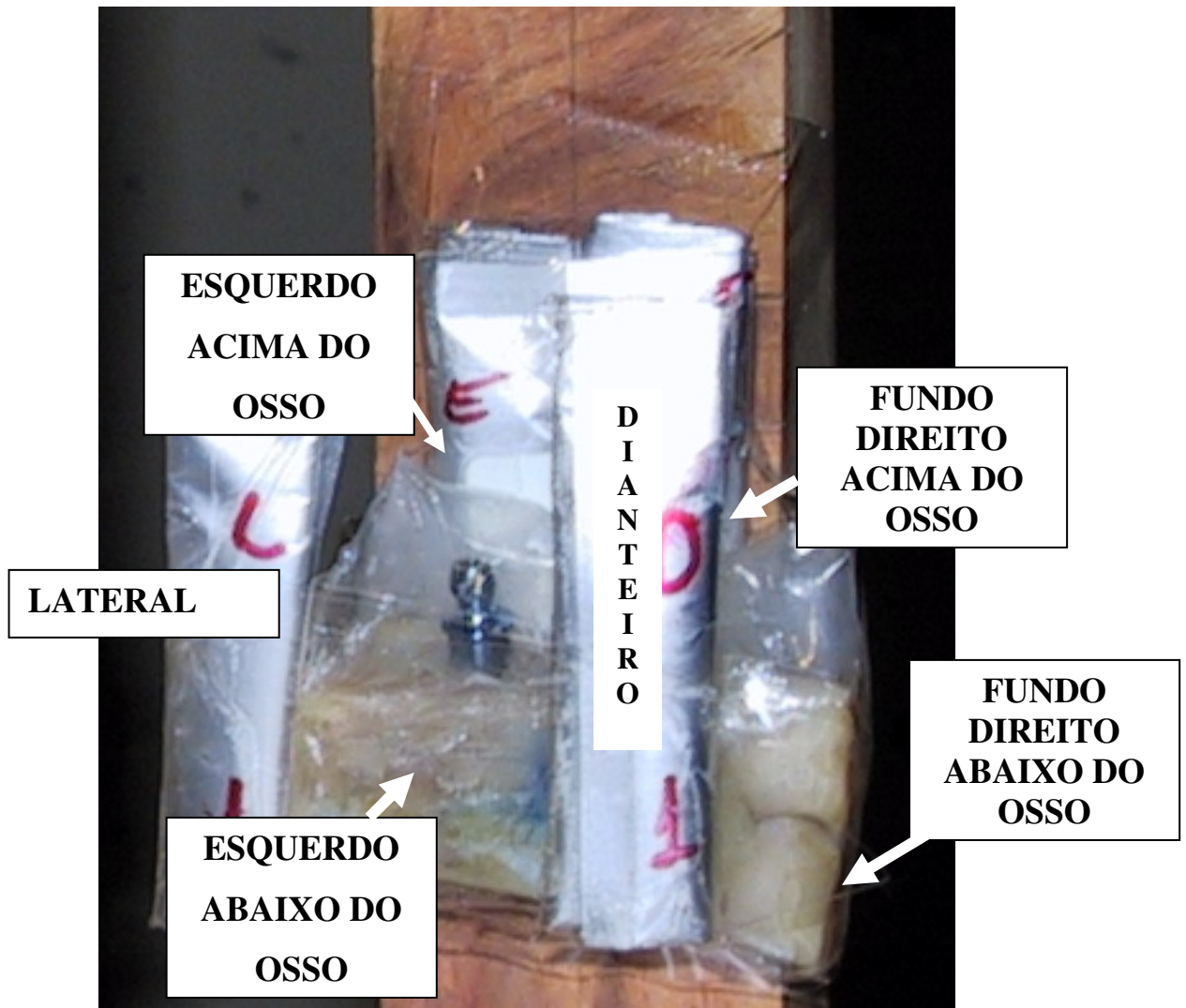
Figura 15 – Disposição dos dosímetros em torno do implante para irradiação
