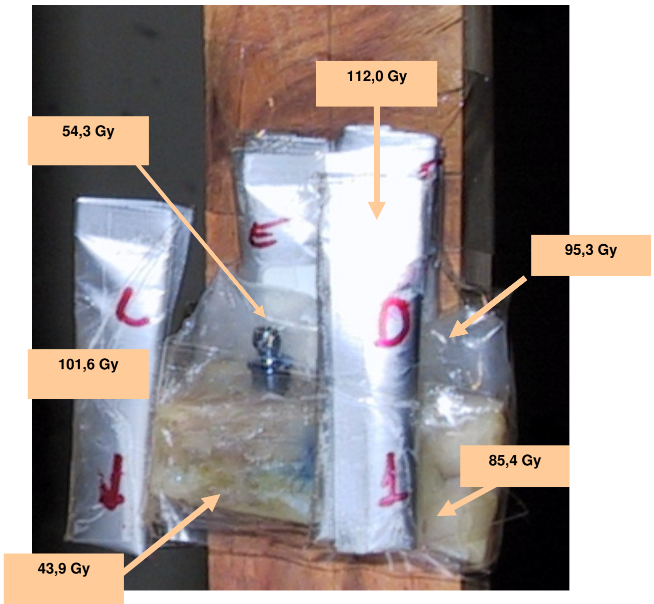
Figura 17 – Valores obtidos após irradiação do implante com radiação gama (100Gy), amostra 1
