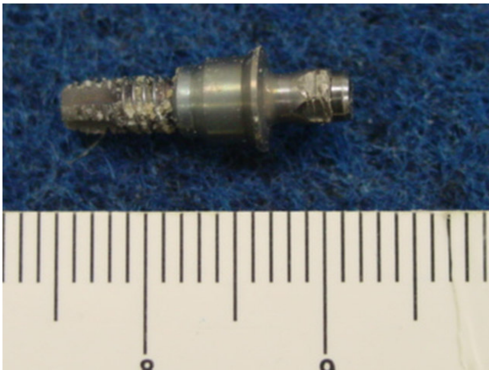
Figura 24 - Aspecto da amostra 3 (sem tratamento de superfície) após irradiação da superfície
