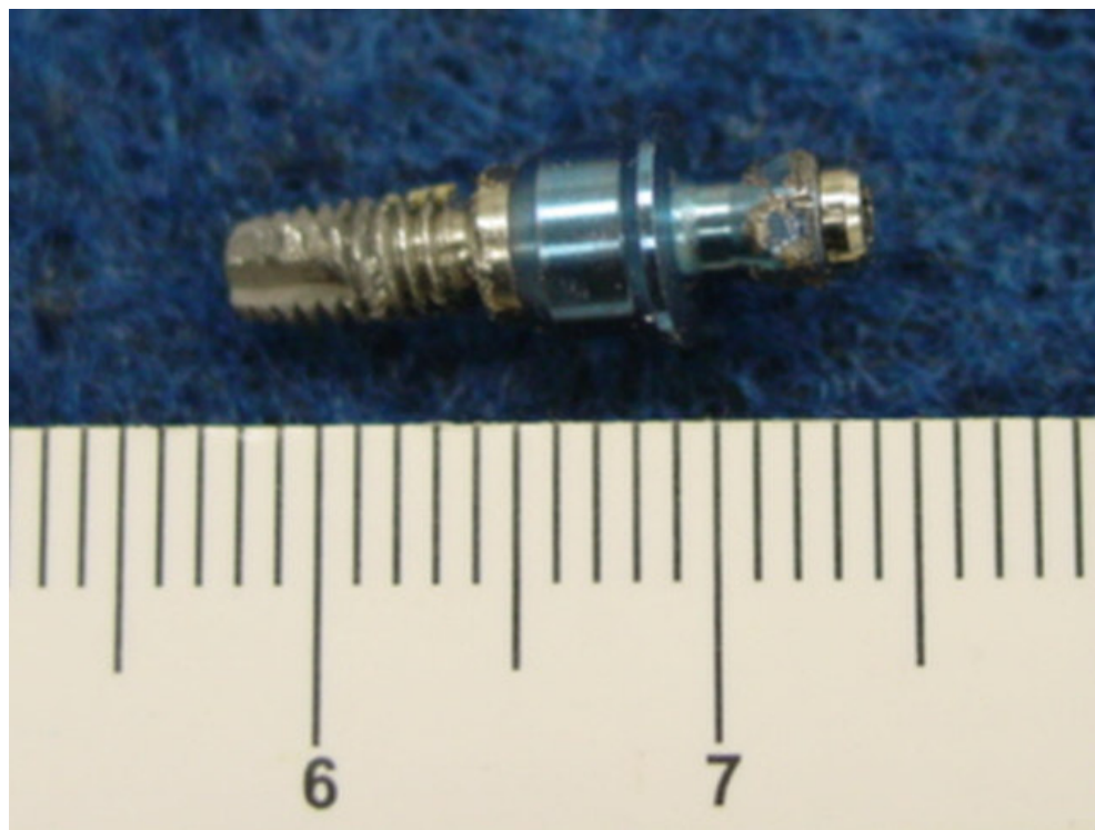
Figura 26 - Aspecto da amostra 5 (100 \mu\text{m} ) após irradiação da superfície
