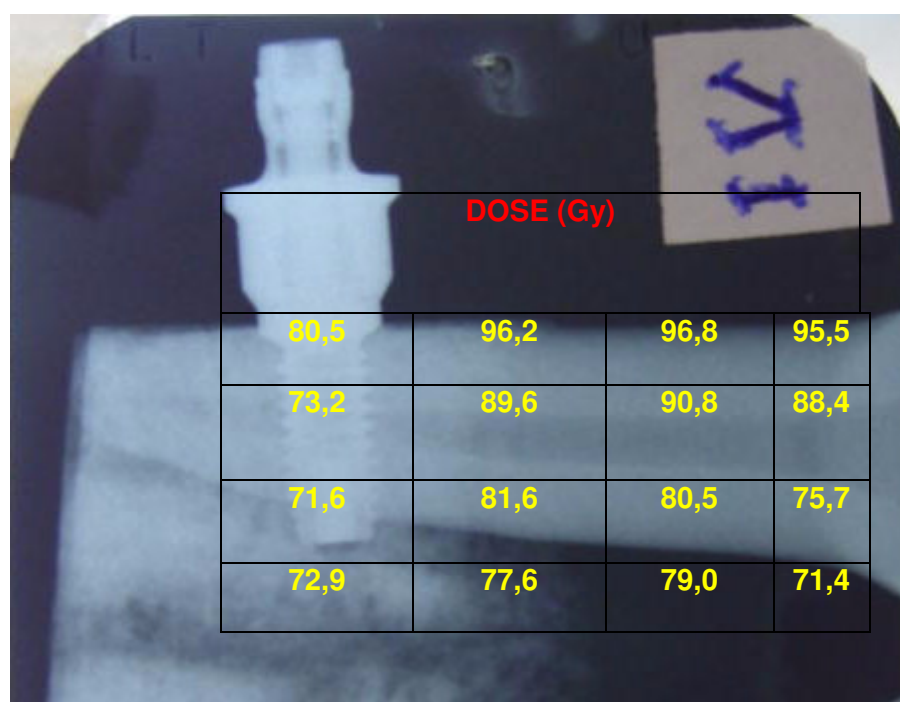
Figura 20 – Valores obtidos para implante de titânio com revestimento (50 \mu m), amostra 4
