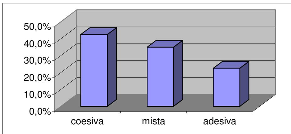
**Figura 14** – Gráfico da quantidade percentual dos tipos de fratura obtidos nos ensaios de resistência ao cisalhamento
