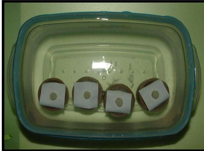
**Figura 9** – Inserção dos corpos-de-prova em água destilada
