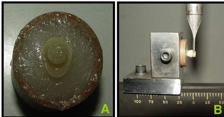
**Figura 10** – Teste de resistência ao cisalhamento
