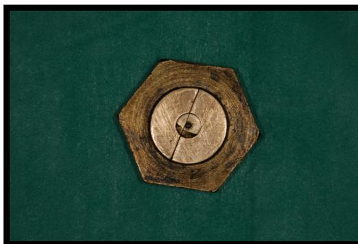
**Figura 4** – Dispositivo metálico utilizado para a confecção das pastilhas de cerâmica
