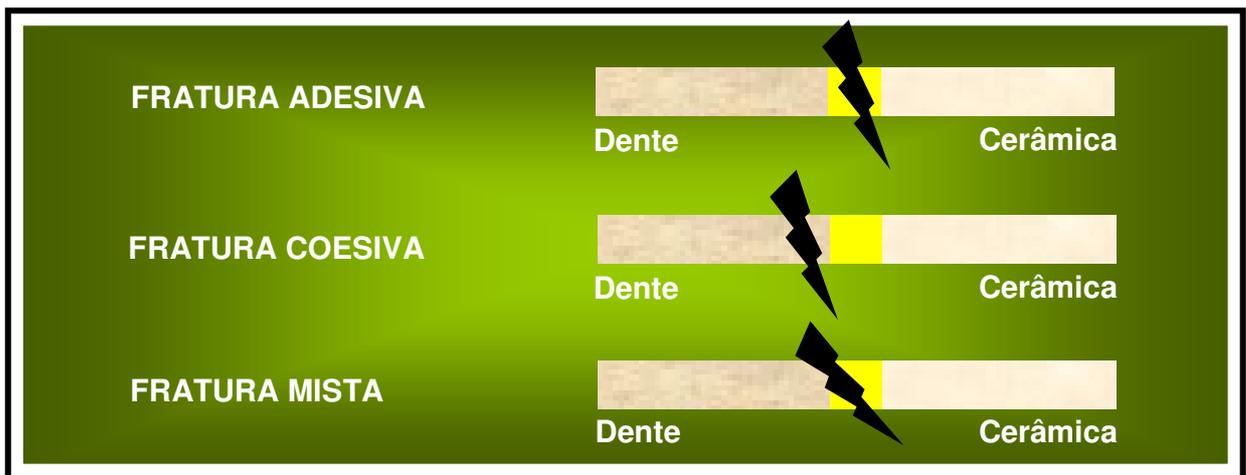
Figura 11 – Tipos de fratura
