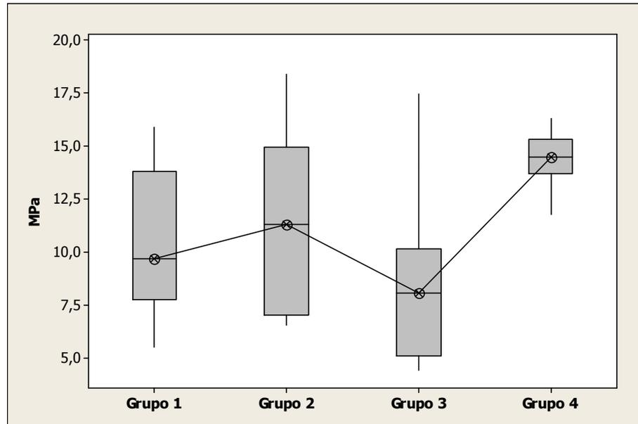
**Figura 13** – Esquema dos cinco números (Box-Plot) dos dados de resistência ao cisalhamento (Mpa) dos grupos experimentais
