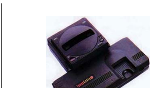
Fig. 51 - O acessório Turbo CD era destacável e utilizado em aparelhos de som, para ouvir CDs.
