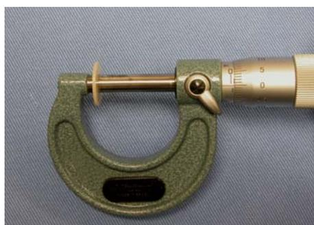
Fig 10: Micrômetro
