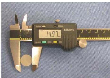
Fig 9: Paquímetro digital
