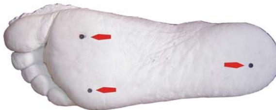
FIGURA 3.9 - Marcação dos pontos para base de referência em XYZ
