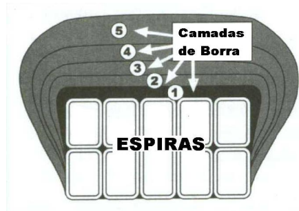
Figura 20 - Seção transversal das espiras de um transformador [17].
