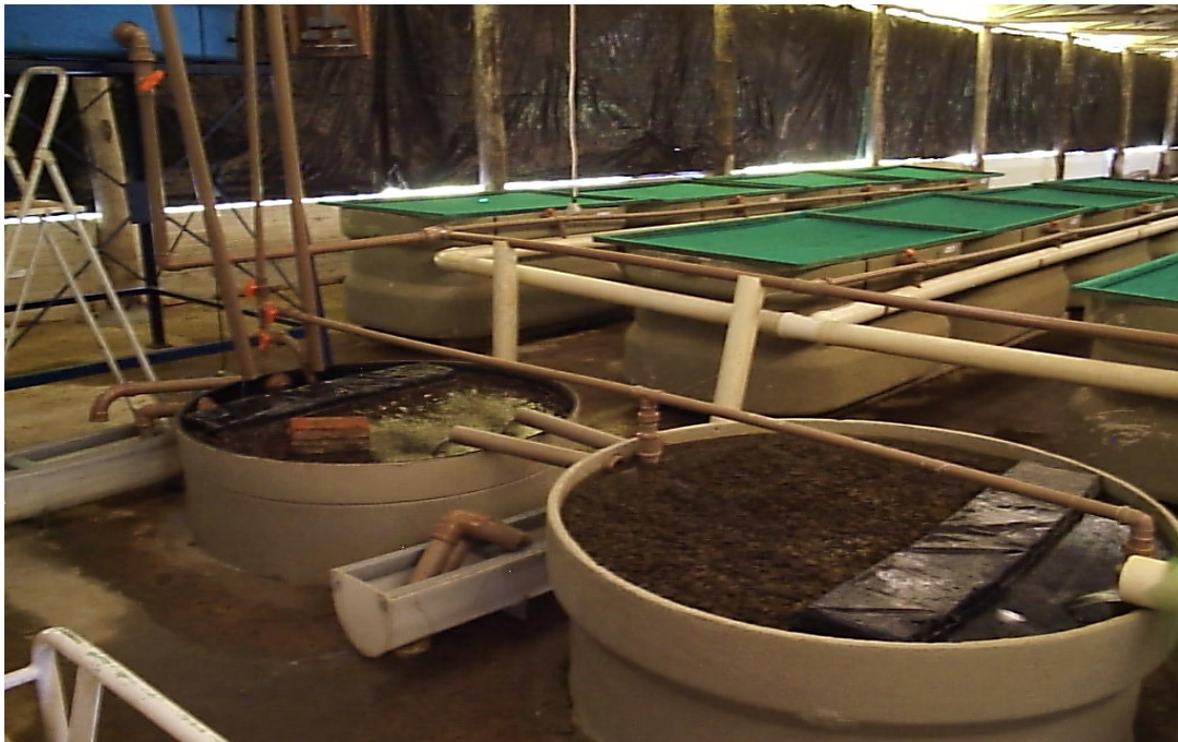
Figura 2 – Filtros biológicos para a recuperação da qualidade da água.
