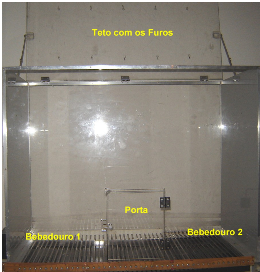
Figura 2 : Fotografia frontal da Câmara de Insight. Na figura encontram-se identificados os bebedouros, a porta convencional e o teto aberto.
