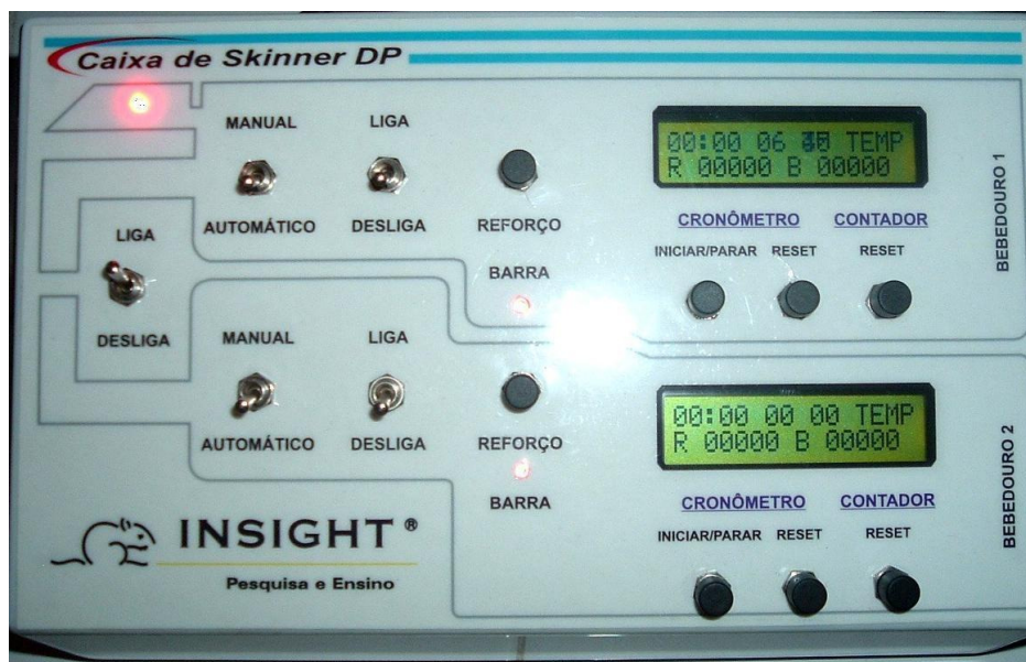
Figura 6 : Caixa de Controle dos Bebedouros da “Insight Equipamentos”. Inclui: Cronômetro e contador de respostas e controle (manual/ automático e liga/ desliga) para cada bebedouro ( 1 e 2).
