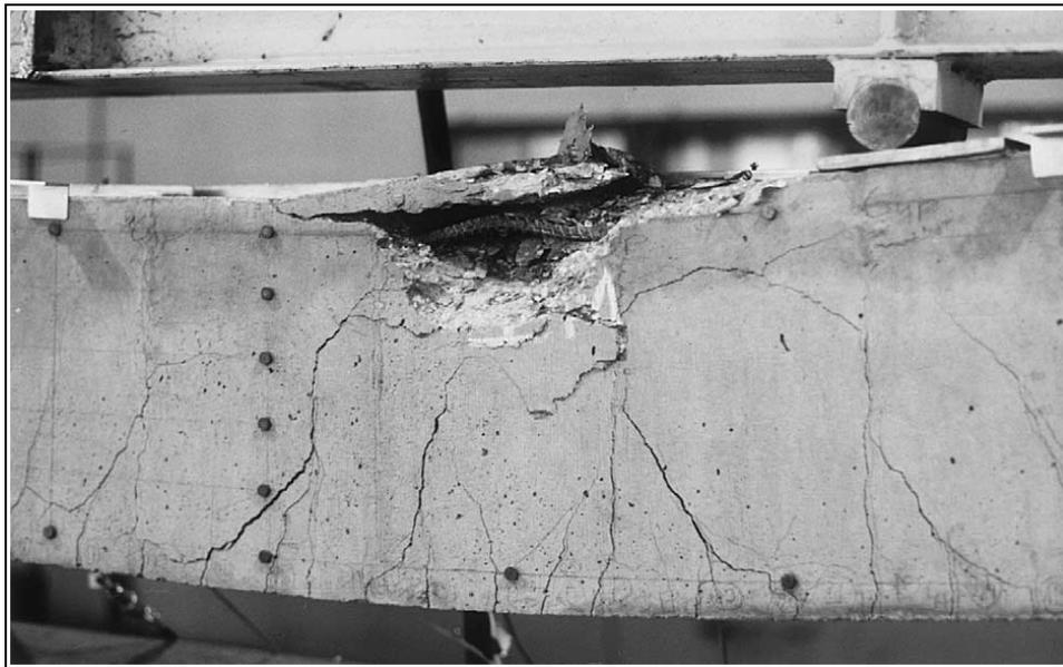
*Figura 2.30 - Esmagamento do concreto na flexão (Kaminska, 2002)*
