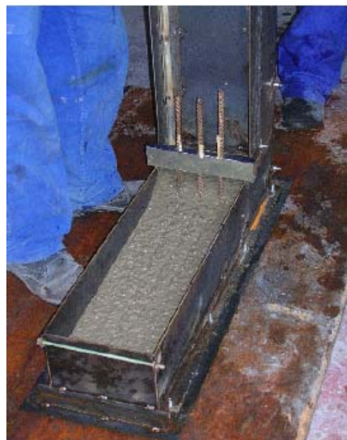
Figura 2.16 – Ensaio da caixa L (GOBBI &amp; AMARAL, 2005)
