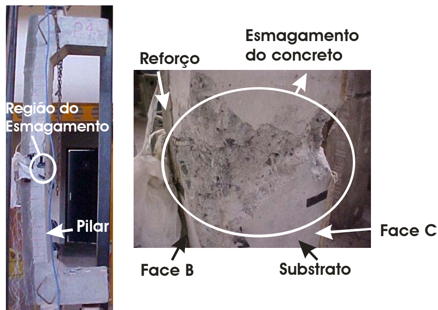
Figura 4.53 – Fotografia do pilar PT12 (reforçado à tração) após a ruptura
