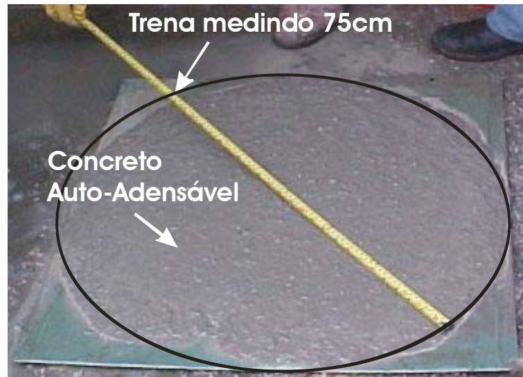
Figura 3.24 – Espalhamento do material de reforço (ensaio de espalhamento)
