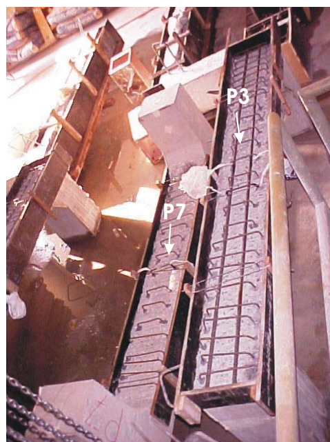
Figura 3.21 – Fotografia da colagem dos conectores ao pilar e forma preparada para receber o novo material
