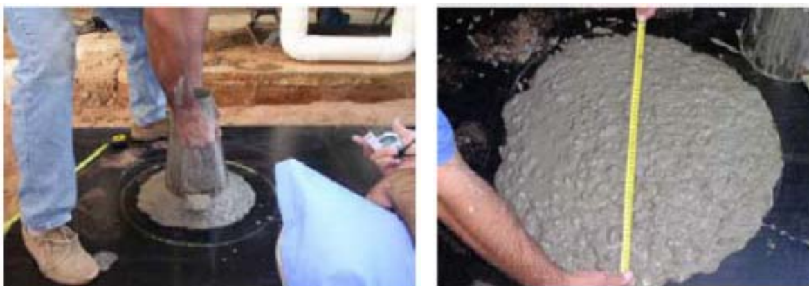
Figura 2.14 – Ensaio de espalhamento (BESSON & ISA, 2005)
