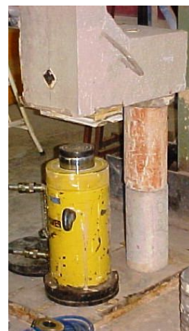
(f) pilar apoiado sobre corpos-de-prova
