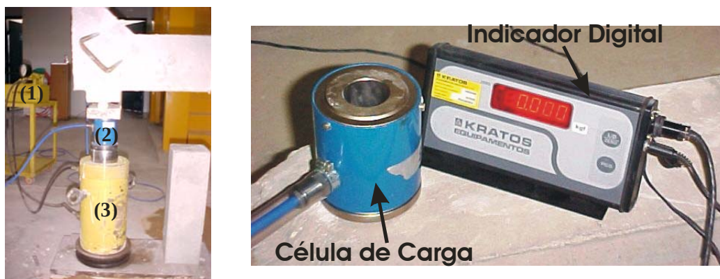
(1)bomba hidráulica de ação manual; (2)célula de carga; (3)atuador hidráulico de 1500 kN Figura 3.10 – Conjunto bomba, atuador hidráulico, célula de carga e indicador digital
