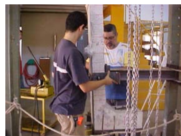
(c) travamento do pilar
