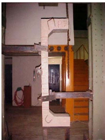
(d) pilar travado
