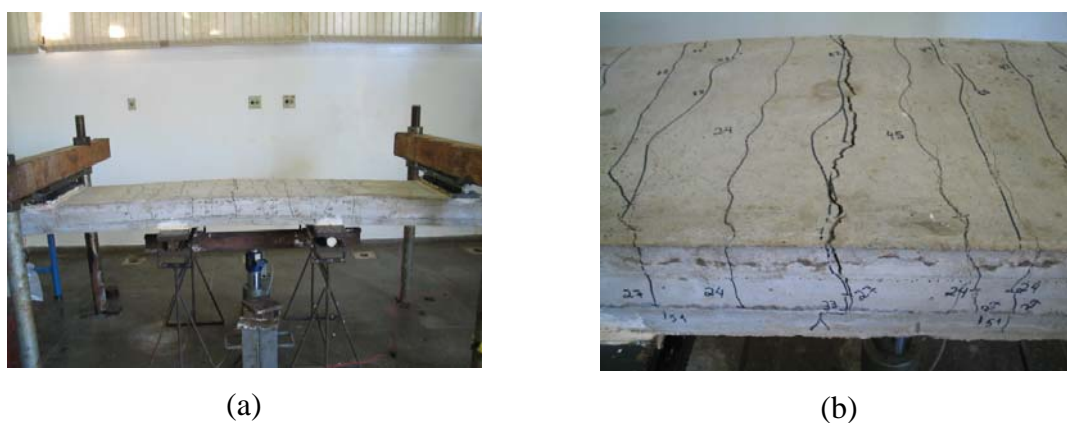
Figura 5.5 – Configuração das fissuras no painel P-2L-PP-45.
