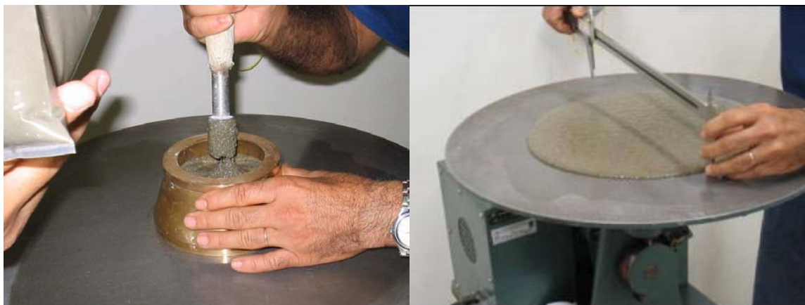
Figura 3.1 – Determinação do índice de consistência conforme a NBR-13276/02 (ABNT, 2002)
