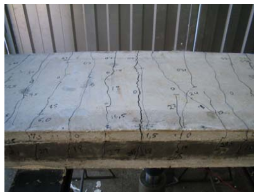
Figura 5.3 – Configuração das fissuras no painel P-SL-45.
