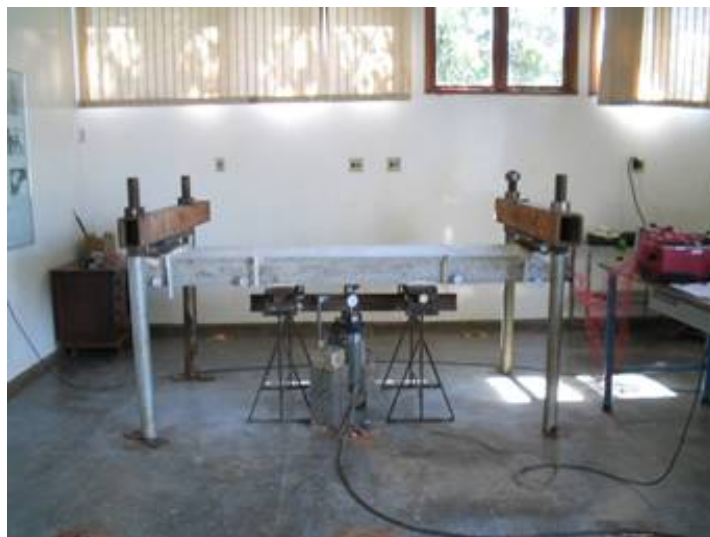
Figura 4.12 - Esquema de ensaio à flexão.
