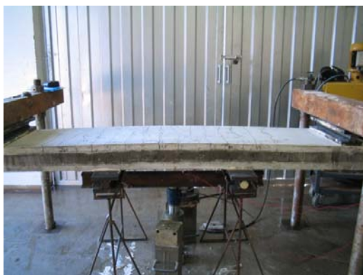
Figura 5.3 – Configuração das fissuras no painel P-SL-45.
