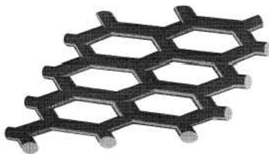
Figura II.7 -- Estrutura de poros da MCM-22 [19].
