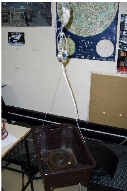
Figura 31: Calibração da Célula de Carga Desenvolvida
