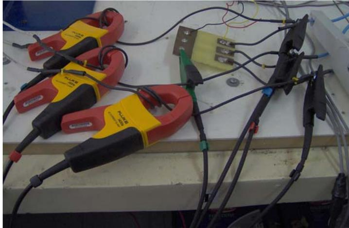
**Fig. 6.15 Sondas de corrente e garras de tensão do registrador instaladas nas três fases do GSIP**
