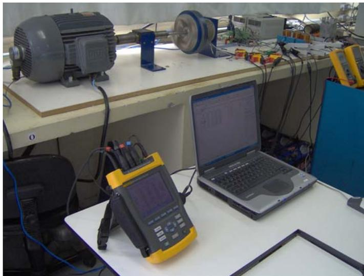
**Fig. 6.14 Registrador de qualidade de energia Fluke 430.**
