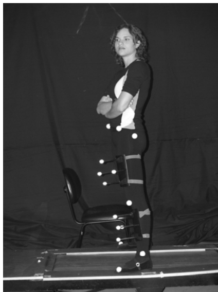
Figura 46: Marcadores anatômicos em ensaio de captura de movimentos
