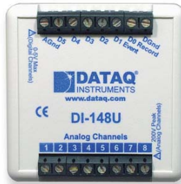
Figura 22: O DataQ, Hardware de Aquisição de dados (8 canais)
