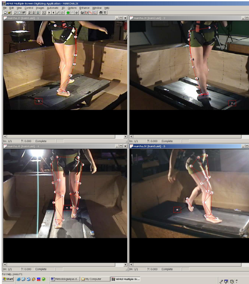
Figura 55: Processo de digitalização pontos de calibração, os segmentos e articulações do corpo.
