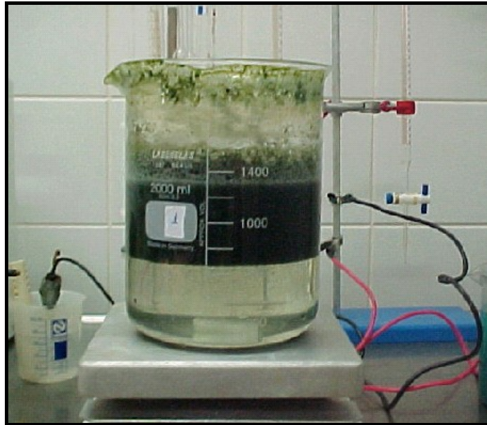
Figura 11 – Aspecto da coagulação/flotação com o auxílio de polieletrólito
