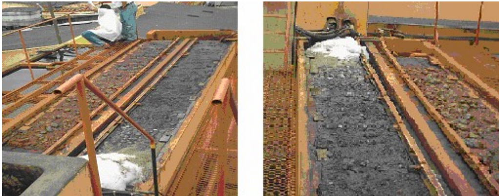
Figura 12 – Vista do reator eletrolítico horizontal onde se observa os resíduos flotados (cor escura).
