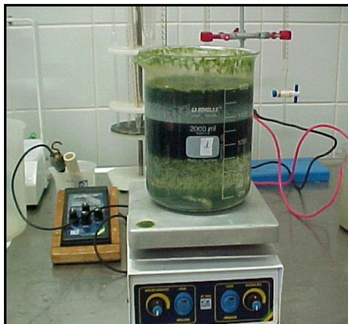
Figura 10 – Aspecto da coagulação/flotação sem o auxílio de polieletrólito
