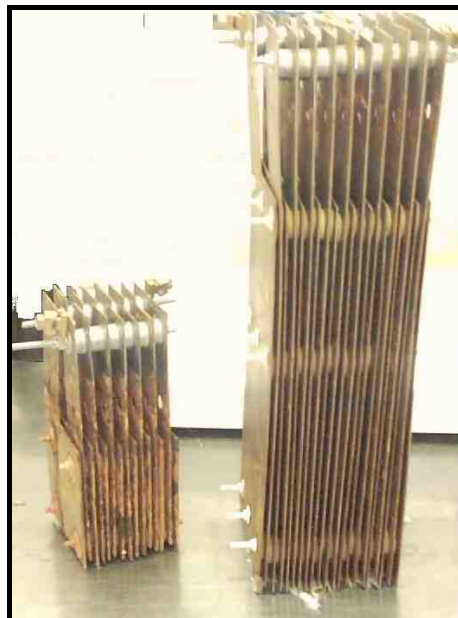
Figura 6 – Aspectos dos eletrodos de placas de aço usadas no reator em batelada e no reator contínuo
