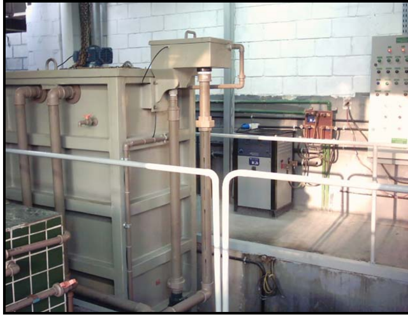
Figura 19 -Vista do Reator Eletrolítico, da fonte retificadora de corrente contínua e do painel de controle do processo.
