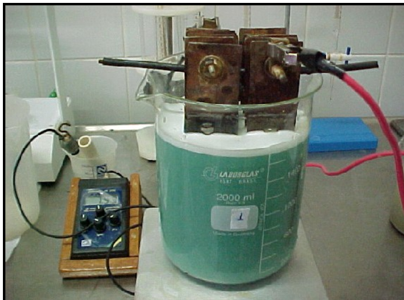
Figura 8 – Início do tratamento com o fluido hidráulico de cor verde
