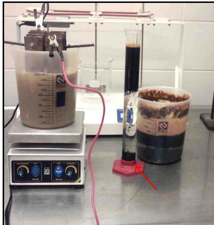
Figura 7 – Processo mostrando a maior remoção por flotação do efluente oleoso em relação à sedimentação
