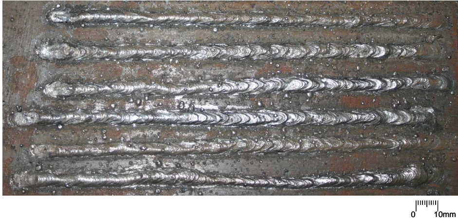
Figura 5.2: Cordões de solda obtidos com a regulagem manual do mergulho do eletrodo.
