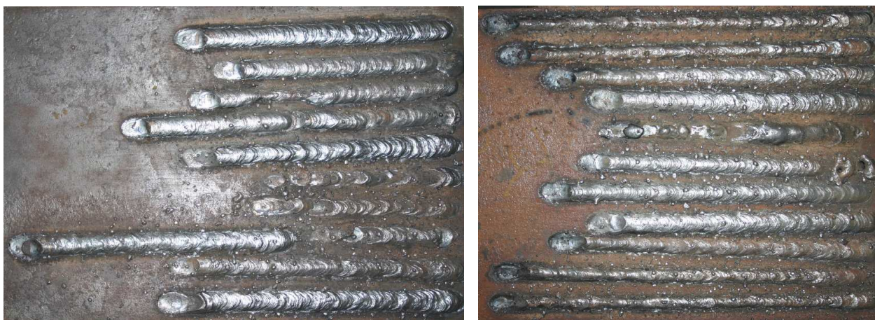
Figura 5.7: Cordões de solda obtidos durante a regulagem dos parâmetros de soldagem (corrente, tensão de referência e velocidade).
