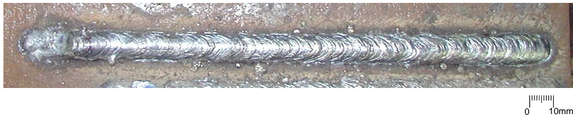
Figura 5.8: Aspecto do cordão de solda utilizando velocidade de 2,5mm/s, corrente de 150A e tensão de referência de 20V.
