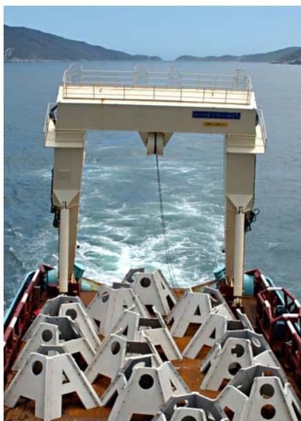
**Figura 72** - Módulos de concreto sendo instalados
