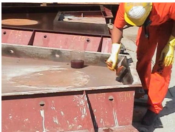
**Figura 67** - Aplicação do desmoldante.
