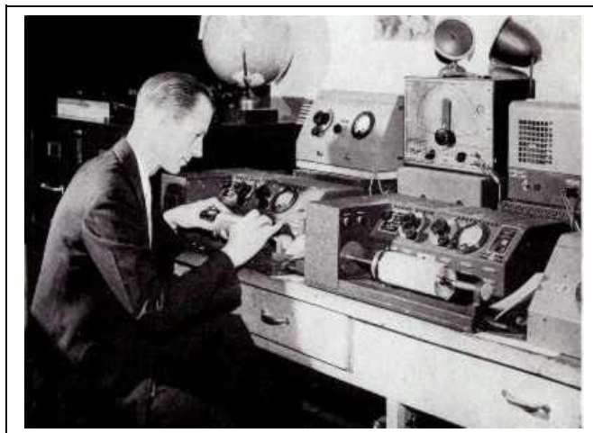
Ilustração 15 - Aparelho de transmissão e recepção de radiofoto em uso (1940-45)
