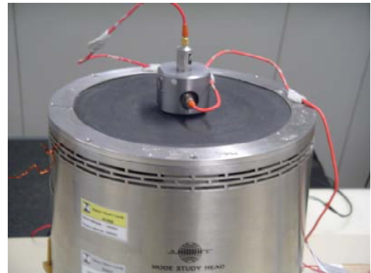
Figura 7 - Calibração Absoluta e Comparativa de transdutor de vibrações.
