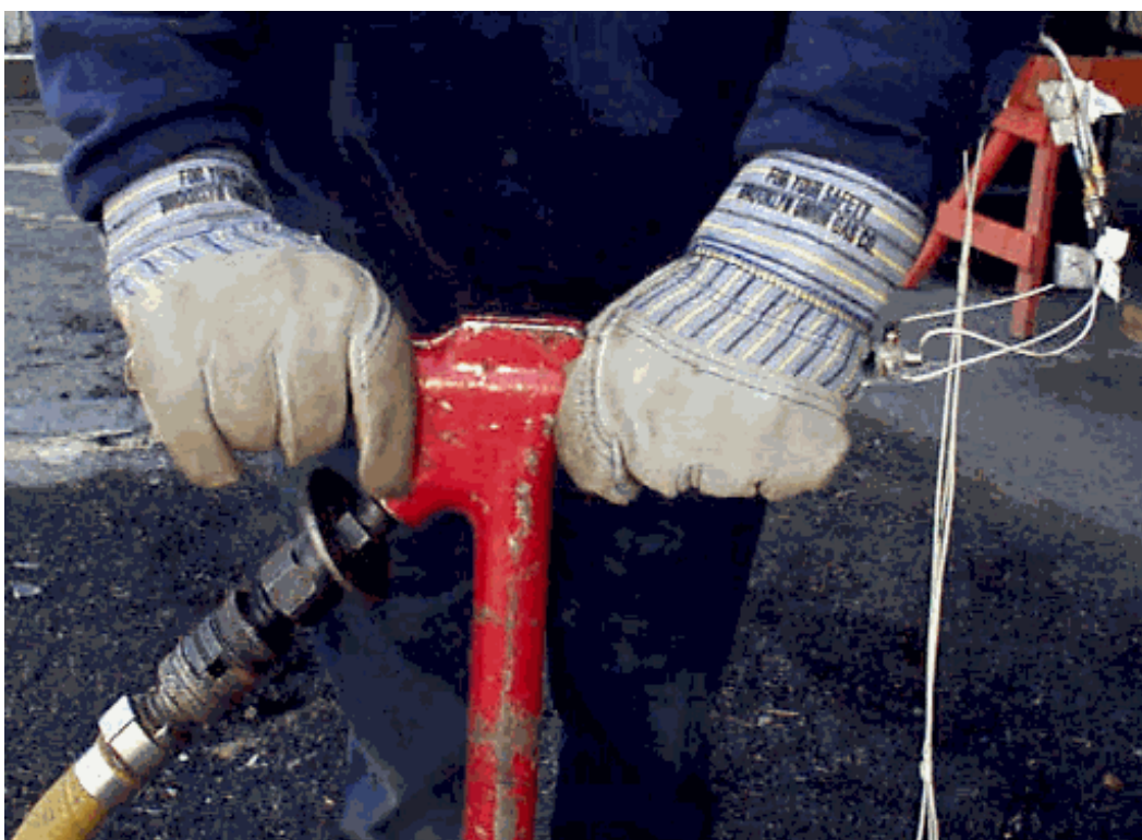
Figura 27 - Montagem para medição de transdutor em britadeira
