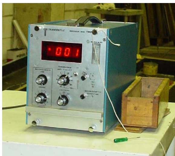
Figura 5.7 Indicador portátil interligado ao transdutor de deslocamento
