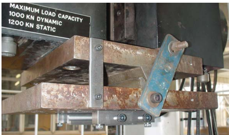
Figura 5.18 Detalhe da “faca” da rótula cilíndrica
