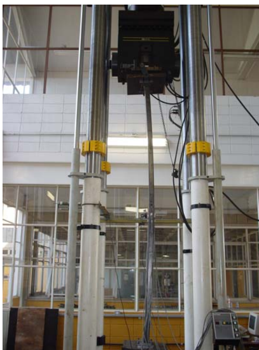
Figura 5.30 Resistência máxima: modo global de flexão em torno do eixo de menor inércia: detalhe da flexão do perfil Ue 125x50x25x3,88mm ( L_r = 2.615\text{mm} )
