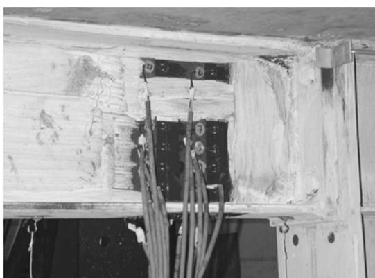
Figura A.4: Extensômetros no perfil de aço – FIGUEIREDO (2004)
