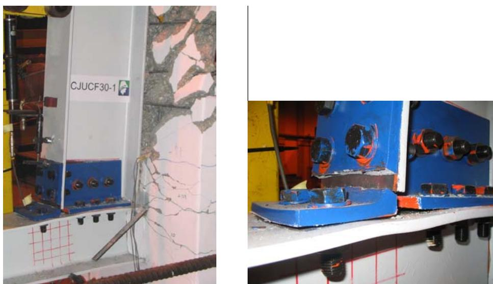
Figura 4.69: Detalhe da ruptura da cantoneira de assento
