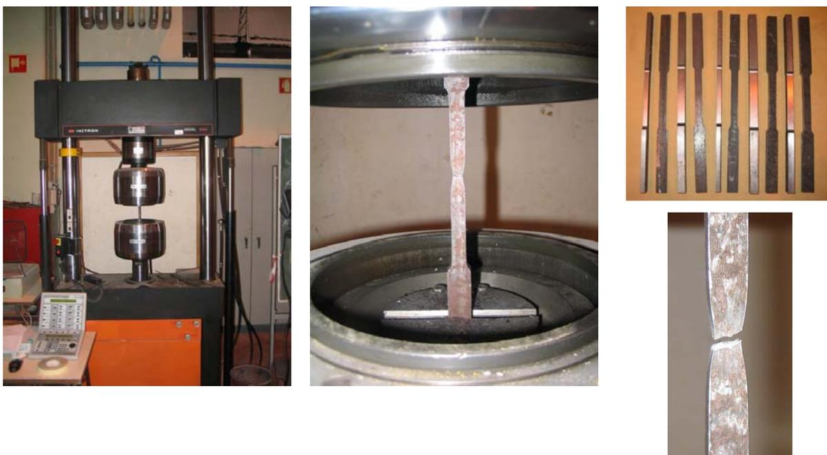
Figura 4.18: Detalhe do ensaio para caracterização do aço
