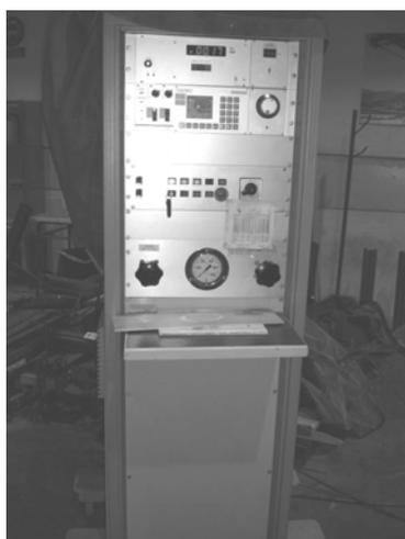
Figura 4.12: Sistema de controle da bomba hidráulica para alimentação dos atuadores
