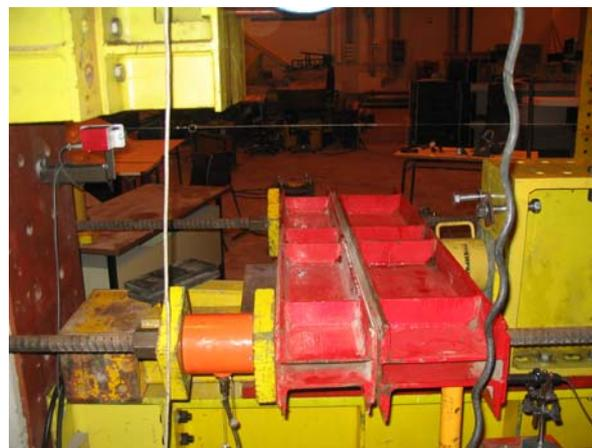
Figura 4.11: Detalhe do segundo procedimento para aplicação da força axial
