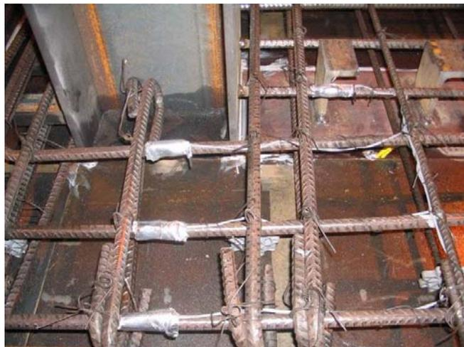
Figura 4.15: Localização dos extensômetros na armadura
