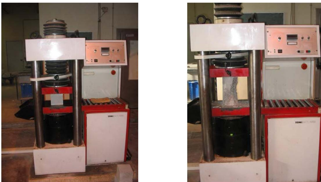
Figura 4.17: Ensaio de caracterização do concreto
