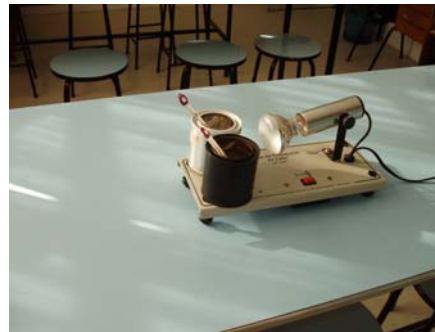
Fig. 3.6: latas com termômetros e lâmpada.
