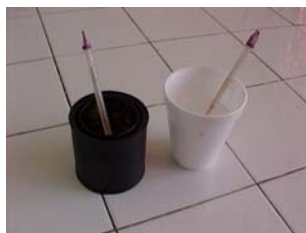
Fig. 3.2: copo e lata com água e termômetros.
