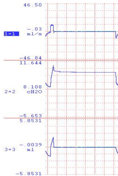
Figura 6: De cima para baixo: sinais de fluxo aéreo, pressão traqueal e volume administrados durante ventilação mecânica com manobra de oclusão das vias aéreas ao final da inspiração. O volume foi obtido por integração eletrônica do sinal de fluxo. A frequência de amostragem utilizada foi de 200 Hz.
