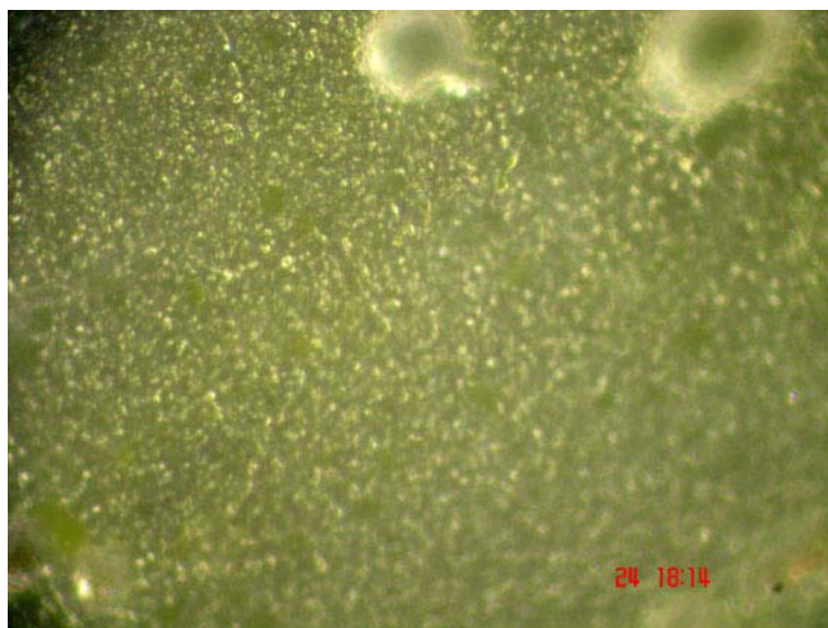
Figura 8- fotomicrografia 4- resina SUPRAFIL. Tempo de polimerização 20s – aparelho de Lâmpada Incandescente
