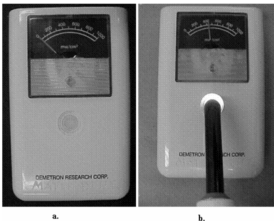
Figura 20 - Em a. foto do radiômetro usado para medir a intensidade da luz do aparelho fotopolimerizador; em b. o aparelho fotopolimerizador de Lâmpada Incandescente sendo aferido.
