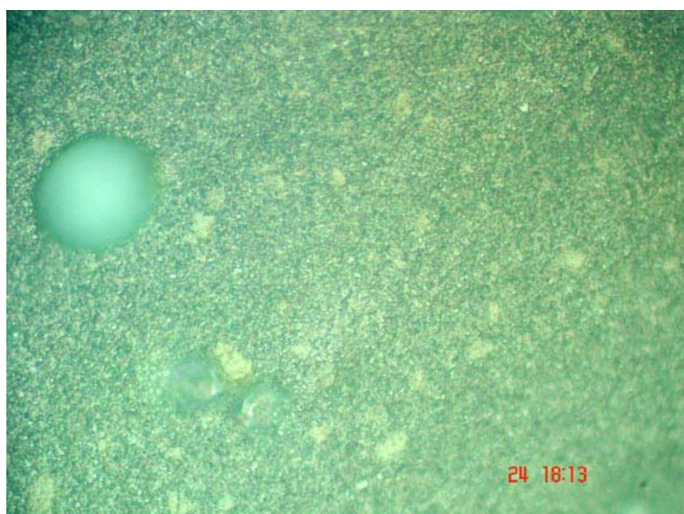
Figura 6- fotomicrografia 2- resina SUPRAFIL. Tempo de polimerização 20s – aparelho de Lâmpada Incandescente
