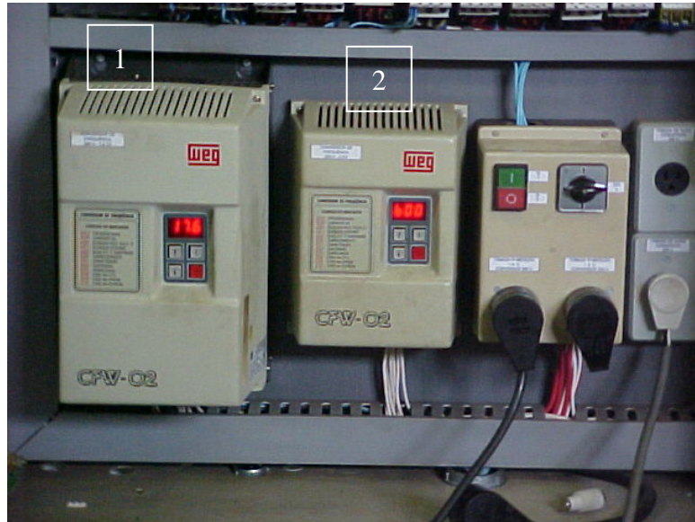
Figura 16 - Fotografia mostrando os dois inversores de frequência utilizados para controlar velocidades da máquina retificadora e do motor elétrico do banco de ensaios.
