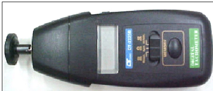
Figura 17 - Tacômetro usado na medição da rotação do cabeçote do banco de ensaios.
