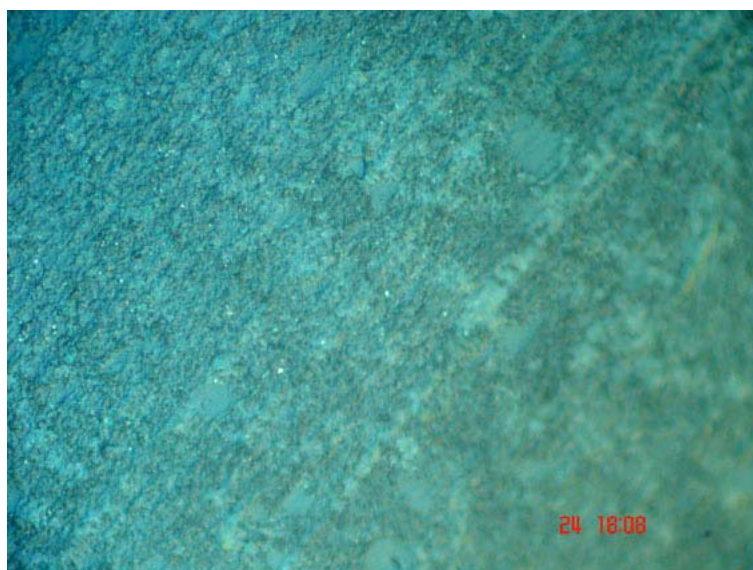
Figura 12- fotomicrografia 4- resina SUPRAFIL. Tempo de polimerização 40s – aparelho de Lâmpada Incandescente
