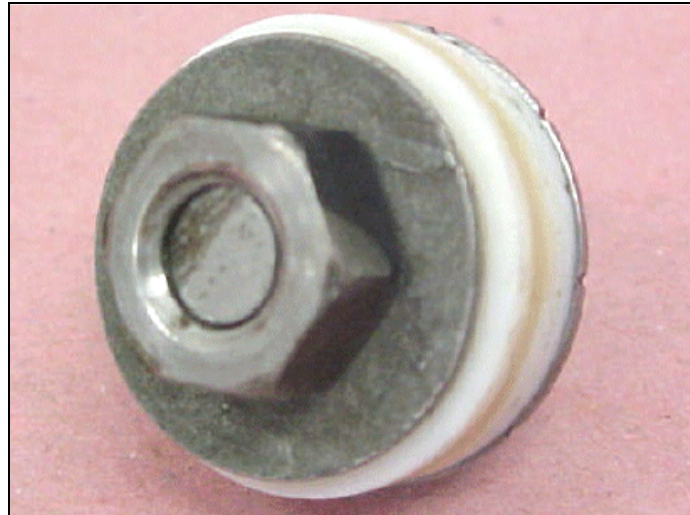
Figura 18 - Matriz de politetrafluoretileno usada na confecção dos discos de resina.
