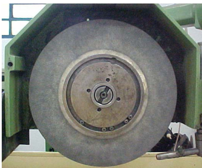
Figura 22 - Rebolo de óxido de alumínio branco usado na retificação dos discos de resina
