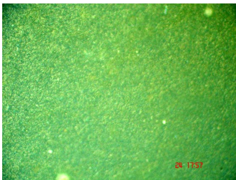
Figura 2- fotomicrografia 2 - resina SUPRAFIL. Tempo de polimerização 10s – aparelho de Lâmpada Incandescente
