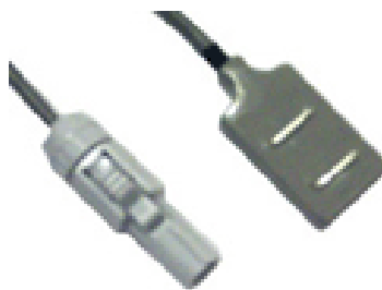
Figura 2.12 – Eletrodo ativo diferencial de superfície fabricado pela Datahominis Tecnologia Ltda.
