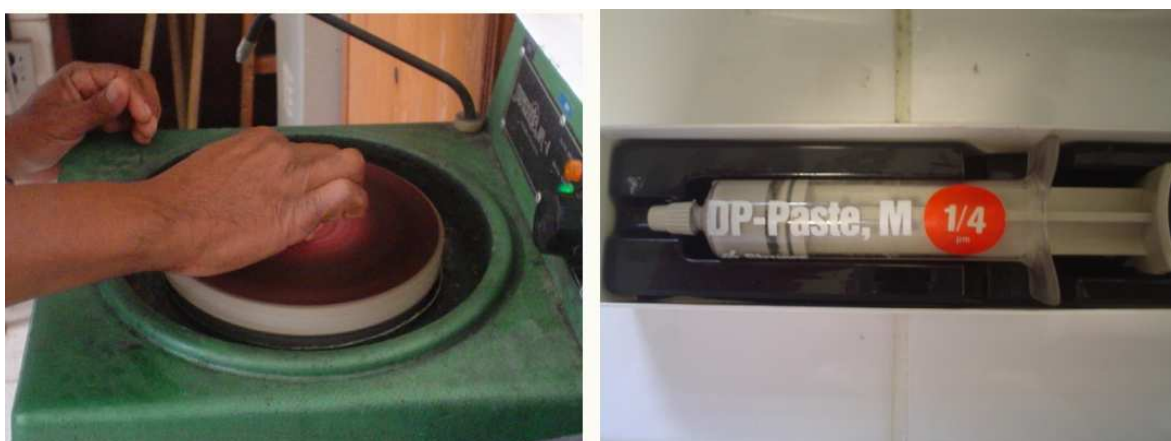
figura 15 - polimento com pasta diamantada
