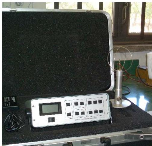
**FIGURA 10** – Anemômetro de fio quente.
