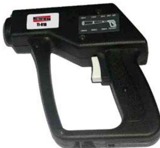
**FIGURA 9** – Termômetro infravermelho digital
