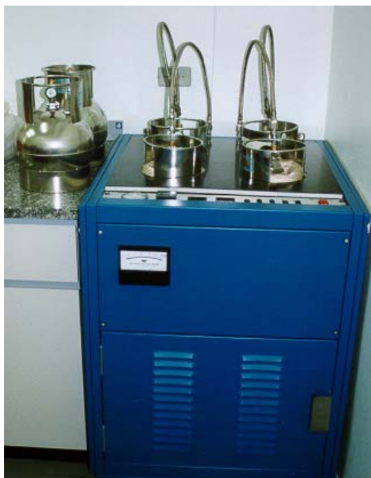
Figura 32 - Sistema de lavagem de canister da Xontech.
