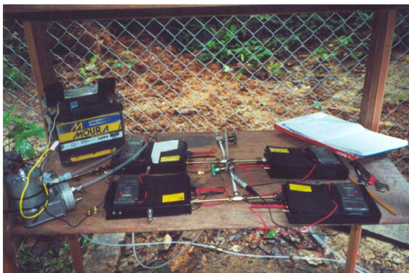
Figura 31 - Foto do sistema de amostragem de ar em tubo adsorvente desenvolvido pelo pesquisador Jim Greemberg do NCAR.
