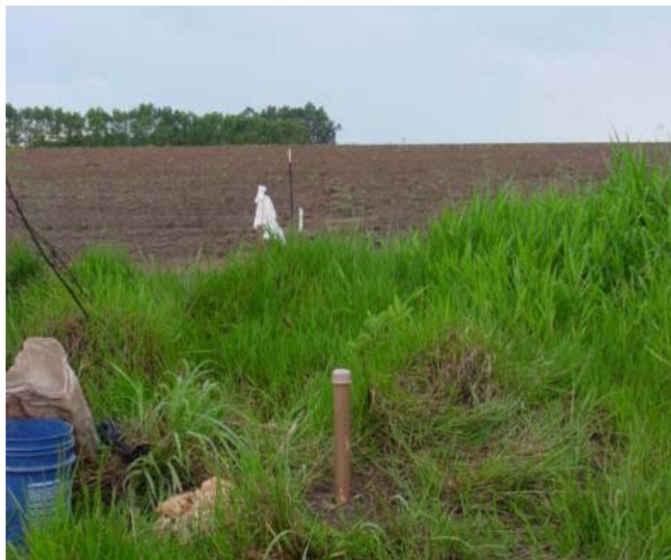
Figura 20 – Vista da vertente onde foram realizados os ensaios geofísicos. Em primeiro plano aparece o piezômetro que indica o início da linha de GPR cuja direção é a borda direita das árvores no topo da vertente. A SEV 1 (bandeira branca na foto) foi realizada a 10 m do piezômetro.
