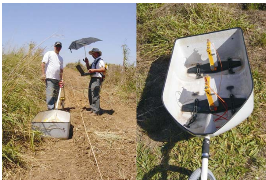
Figura 34 –Linha de GPR no início da vertente com antenas de 200 MHz. (Foto à esquerda). Antenas no rebocador de fibra de vidro (foto à direita).
