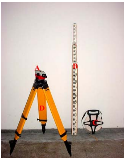
Figura 18 - Equipamento utilizado para realização do nivelamento do terreno. A) – Nível óptico; B) – Régua de Visada; C) - Trena; e D) – Tripé.
