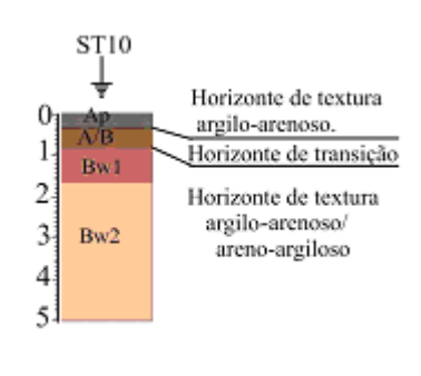
Figura 31 - Perfil de solo no furo de sondagem a trado ST10, 5m antes da SEV5. A escala vertical está em metros. (Modificado de GONÇALVES, 2003).
