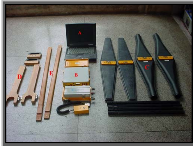
Figura 17 – Conjunto RAMAC/GPR. A) computador portátil. B) unidade de controle central. C) antenas transmissora e receptora de 50 MHz e 100 MHz; D) hastes de transporte das antenas. E) separador das antenas.
