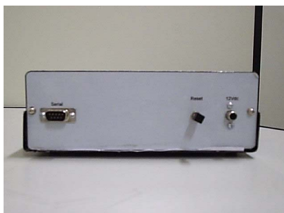
Figura 5.29 Foto do painel traseiro do condicionador
