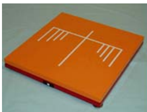
Figura 3.7 Plataforma de força a base de sensores extensométricos ( www.bertec.com ).
