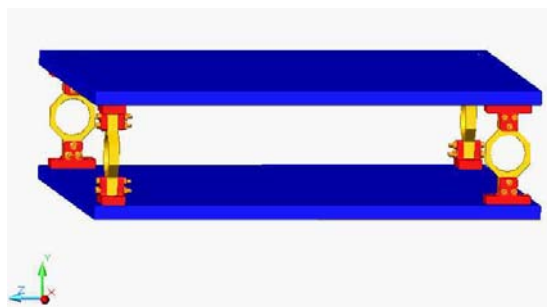
Figura 5.1 Imagem da plataforma de força modelada.
