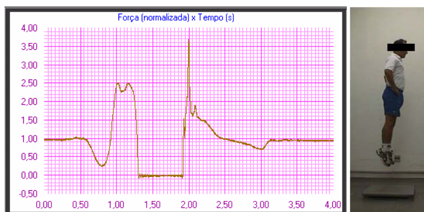
Figura 3.12 Resultado do ensaio de salto vertical completo (Naves, 2001).
