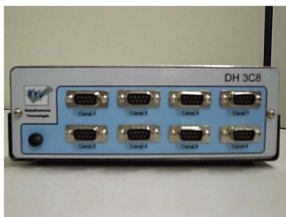
Figura 5.28 Foto do painel frontal do condicionador.
