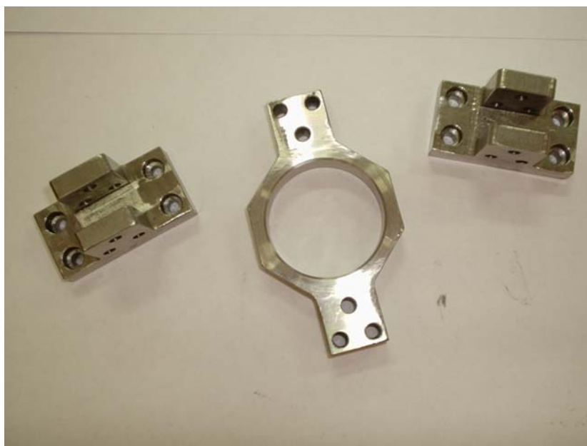
Figura 5.11 Foto da célula de carga e dos suportes usinados.
