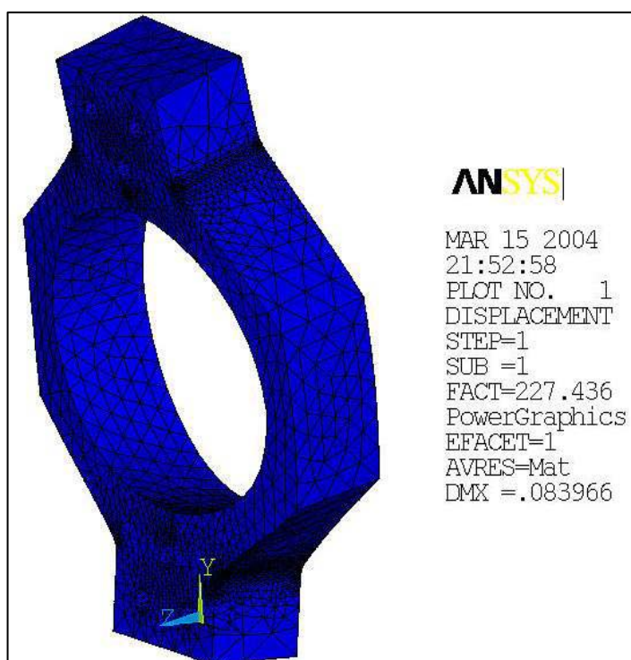
Figura 5.7 Análise da flambagem da peça.
