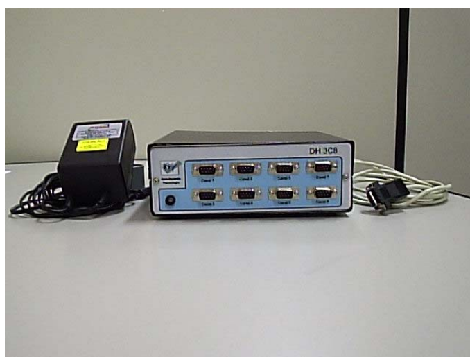
Figura 5.30 Foto da unidade de condicionamento, fonte e cabo
