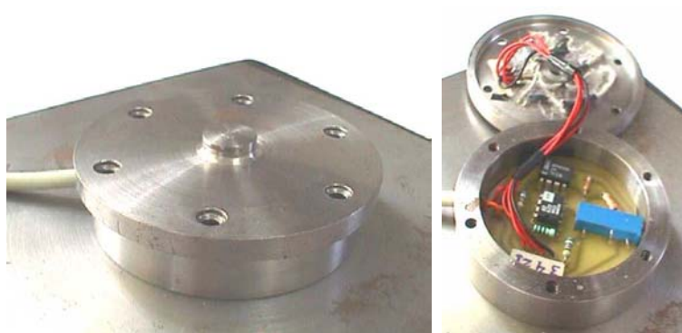
Figura 3.11 Modelo da célula de carga e detalhes da usinagem e do condicionamento do circuito pré-amplificador (Naves, 2001).
