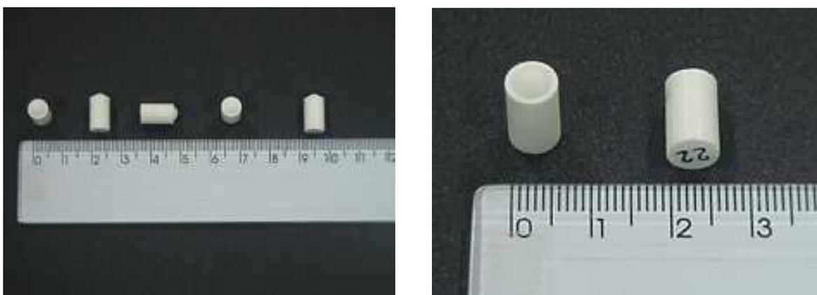
Figura 3.3. Corpos de prova na forma de pinos confeccionados para realização dos ensaios de desgaste.
