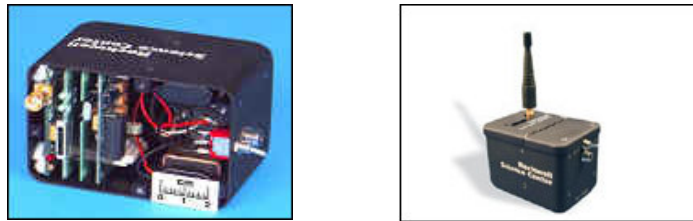
Figura 2.5 WINS, nó-sensor desenvolvido na Universidade da Califórnia.
